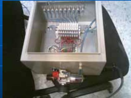
Es parte del sistema de vacío y de chorro de aire para la limpieza de las lentes usadas en el esquema general.
