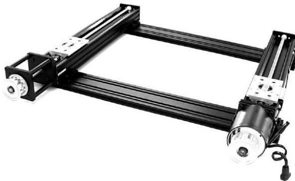
2. Monte los deslizadores en los separadores usando tuercas y abrazaderas de montaje. No apriete aun
