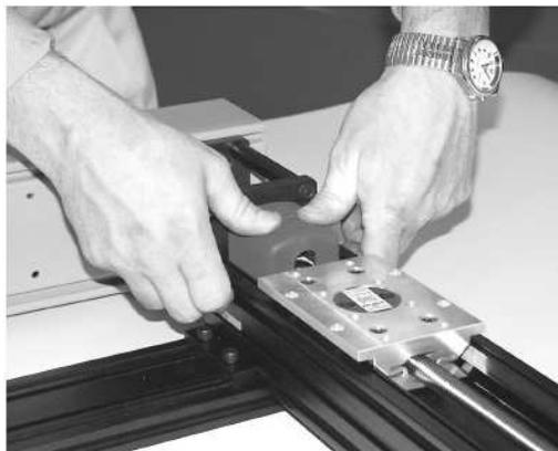
14. Centre la cubierta de la banda sobre los tornillos ubicados en la parte trasera de los motores y cojines de montaje y ajuste.
