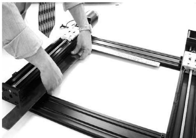
4. Alinee el otro separador de forma paralela con el primero. Ajuste ahora las abrazaderas de montaje del deslizador motorizado con el segundo separador.
